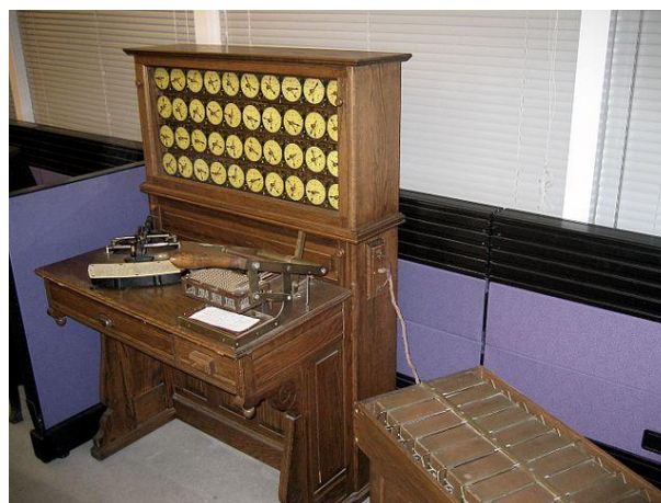
HOLLERITH-Maschine mit Zählwerk (an der Wand), Lochkarten-Stanzer auf dem Tisch und einem Lochkarten-Sortierer (rechts vorne) Q: de.wikipedia.org (Adam Schuster (www.flickr.com))
